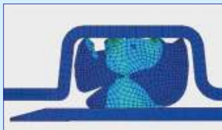
Рисунок 12. Упругие деформации однолепесткового уплотнительного кольца в раструбе
