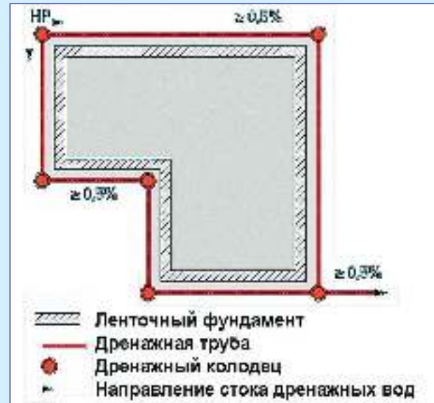
Пример: ленточный фундамент
